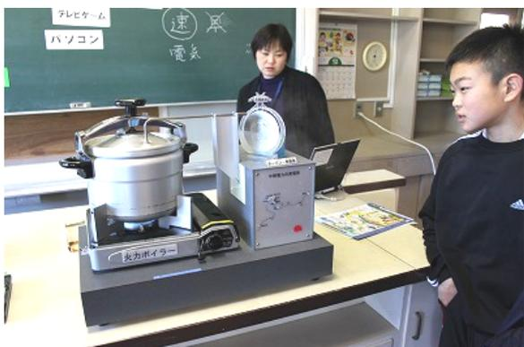
蒸気による発電実験！
